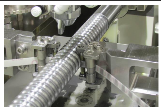
（株）サンシン ポールねじのテーブ研磨装置 NAZEが認定する卓越した技術「蒙技2016」
